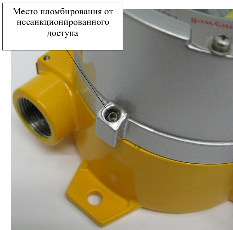
Рисунок 2 – Схема пломбирования газоанализаторов от несанкционированного доступа
