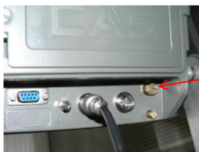
Рисунок 3 – Схема пломбировки от несанкционированного доступа, место нанесения знака поверки для весов
