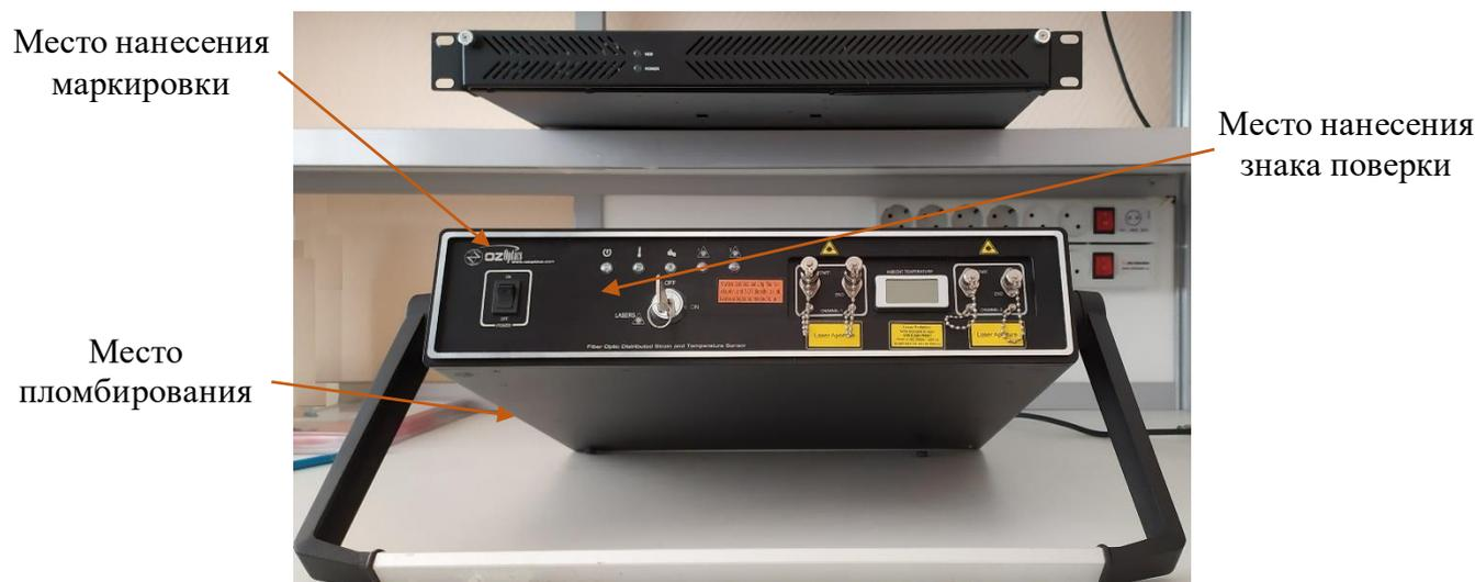
Рисунок 1 – Общий вид анализатора, схема пломбировки от несанкционированного доступа, обозначения мест нанесения маркировки и знака поверки
