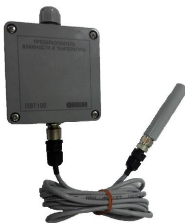
Рисунок 4 - Общий вид преобразователей ПВТ100 исполнения ПВТ100-Н5
