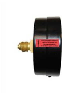
а) Место пломбировки с помощью наклейки
