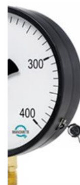
б) Место пломбировки с использованием пломбы
