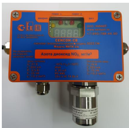
Рисунок 1 - Стационарная одноканальная газоаналитическая система с газоанализатором «Сенсон» исполнения СМ
