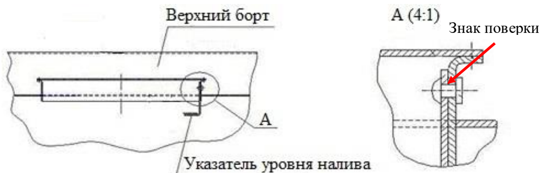
Рисунок 2– Схема пломбировки от несанкционированного доступа, обозначение места нанесения знака поверки
