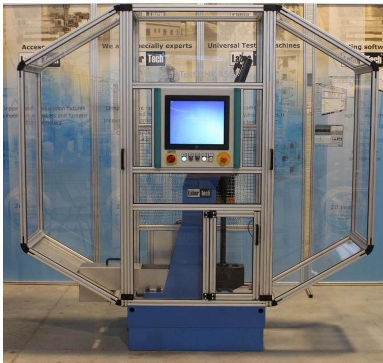
Рисунок 1 – Общий вид копра маятникового LabTest SHK 450J
