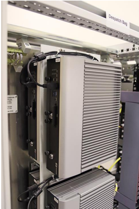
Рисунок 9 – PromPC Axiomtek tBOX321-870-FL. Вид внешний
