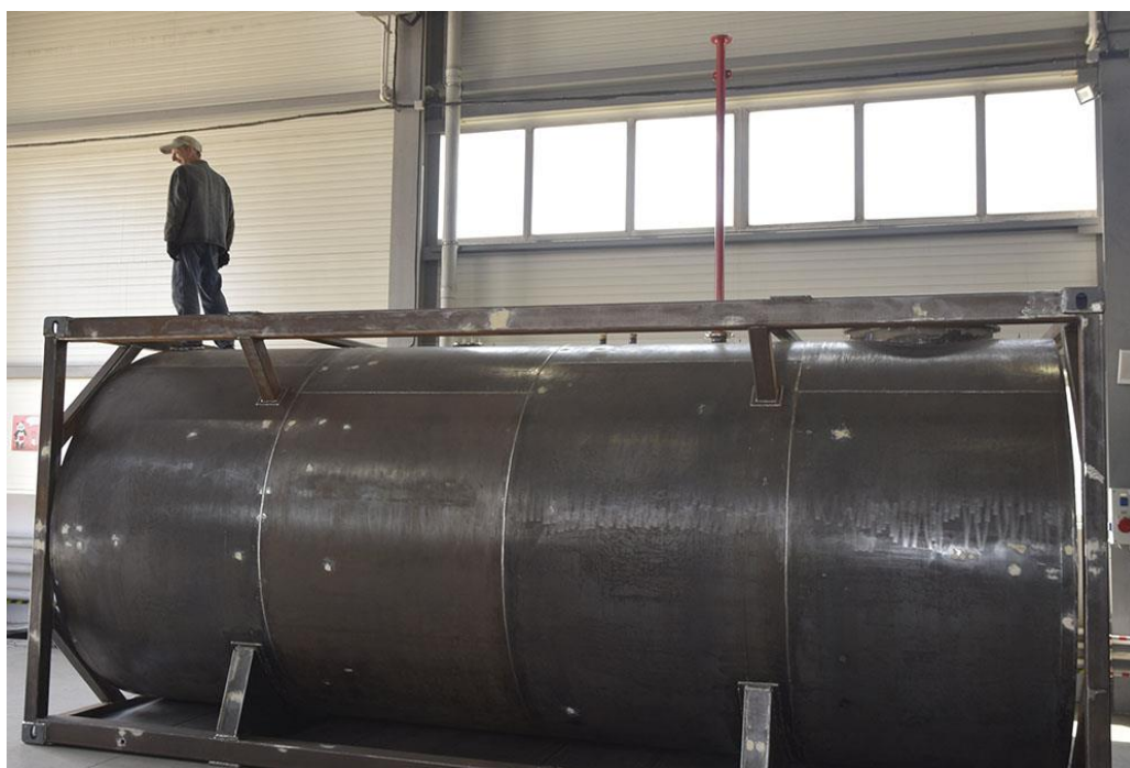
б) резервуар модификации РГСН-20 (5+5+10)
