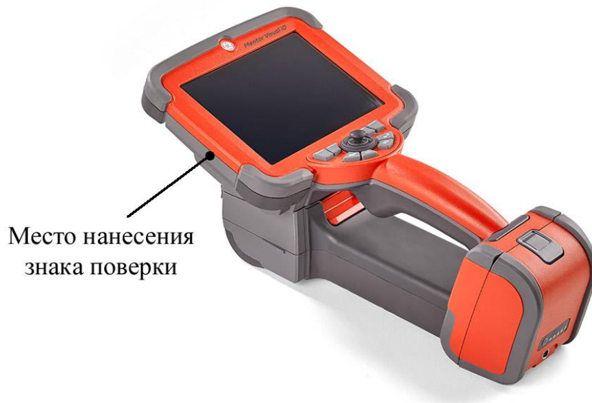
Рисунок 2 - Обозначение места нанесения знака поверки
