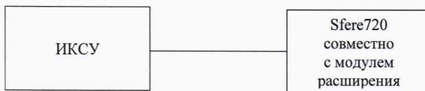
Рисунок 3 – Схема подключения при преобразовании аналоговых входных сигналов силы постоянного тока, аналоговых выходных сигналов напряжения и силы постоянного тока, входных сигналов температуры от термопреобразователей сопротивления Pt100 по ГОСТ 6651
