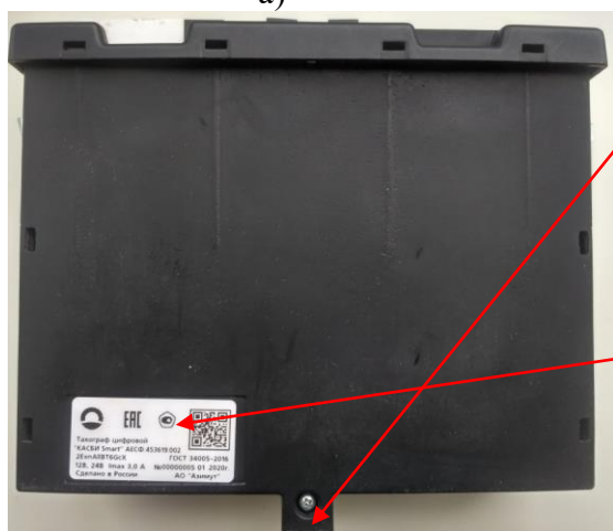
Рисунок 2 – Место размещения знака утверждения типа и схема пломбировки от несанкционированного доступа
