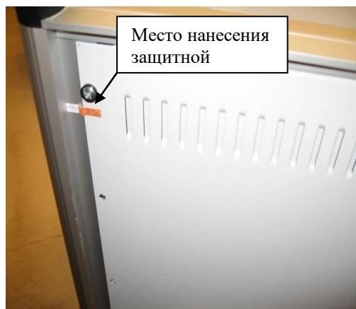
Рисунок 2 - Схема пломбирования корпуса генератора от несанкционированного доступа
