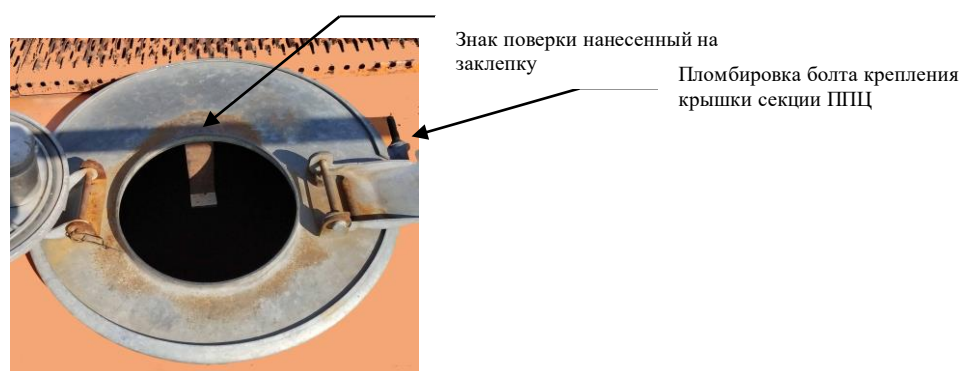
Рисунок 2 – Схема пломбировки от несанкционированного изменения положения указателя уровня налива, обозначение места нанесения знака поверки
