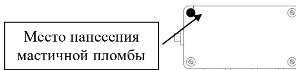
Рисунок 3 – Схема пломбировки корпуса преобразователя
