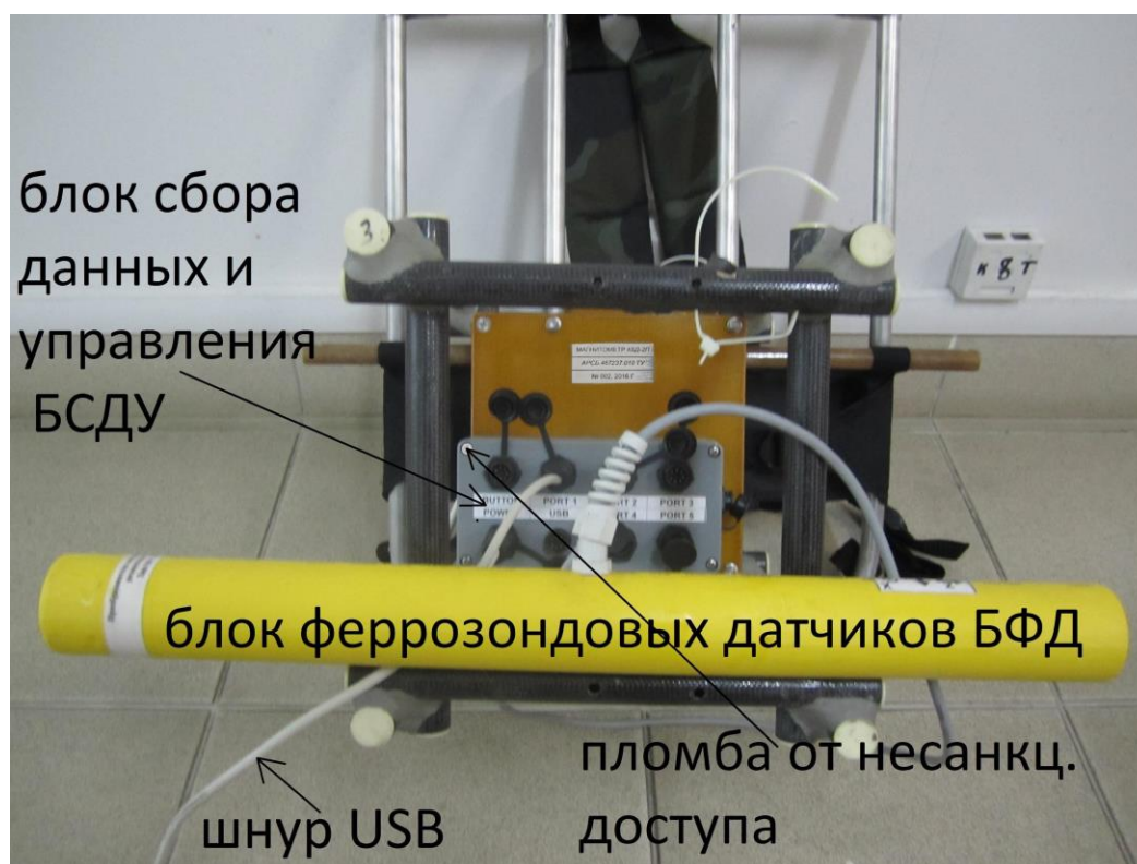
Рисунок 2 - Общий вид блока феррозондовых датчиков магнитометра с блоком управления и шнуром для подключения компьютера без защитного кожуха со схемой пломбировки от несанкционированного доступа
