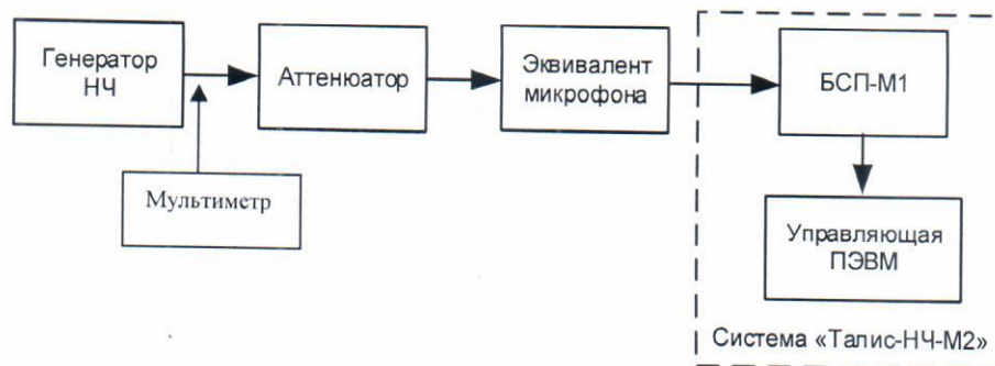
Рисунок 7б - Схема стенда измерения диапазона рабочих частот при измерении звукового давления и нижнего значения диапазона измерения уровня звукового давления
