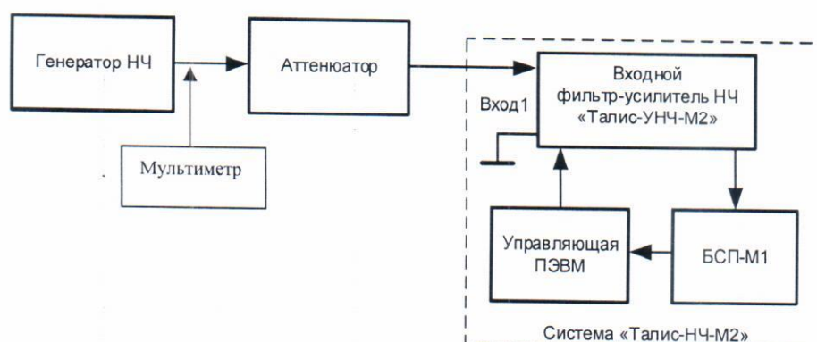
Рисунок 2 – Схема стенда проверки диапазона рабочих частот напряжения переменного тока и диапазона напряжения переменного тока до 300 мВ
