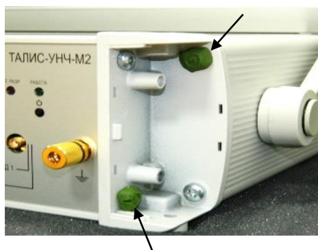
Рисунок 2 - Места для пломбировки от несанкционированного доступа
