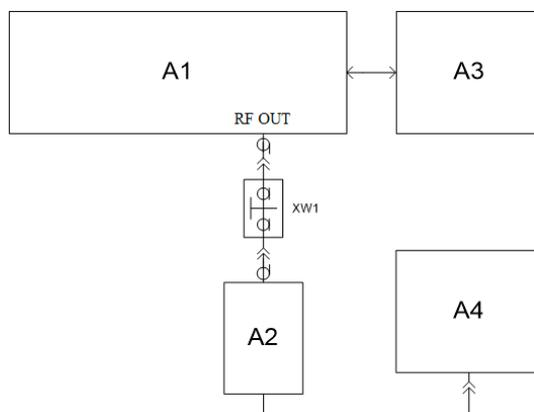
A1 – испытываемый генератор; A2 – преобразователь измерительный ваттметра;
