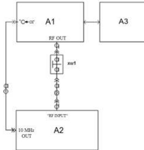
A1 – испытуемый генератор; A2 – анализатор спектра; A3 – ПК;
