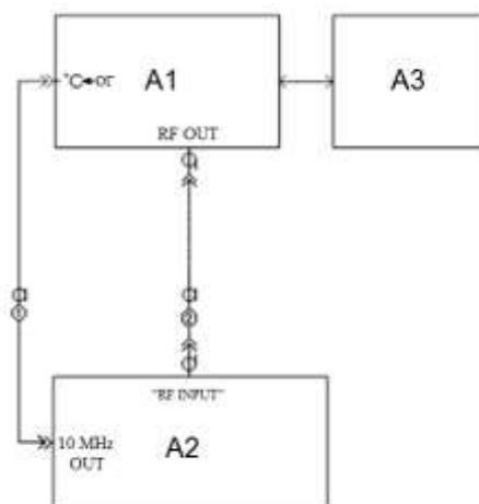
A1 – испытуемый генератор; A2 – анализатор фазового шума FSWP26; A3 – ПК;
