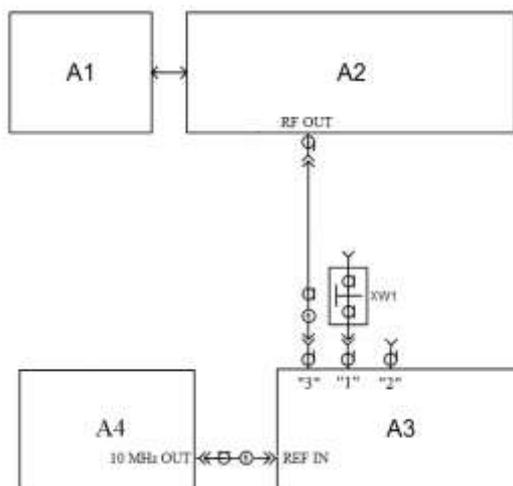
A1 – ПК; A2 – испытуемый генератор; A3 – частотомер; A4-стандарт частоты;
