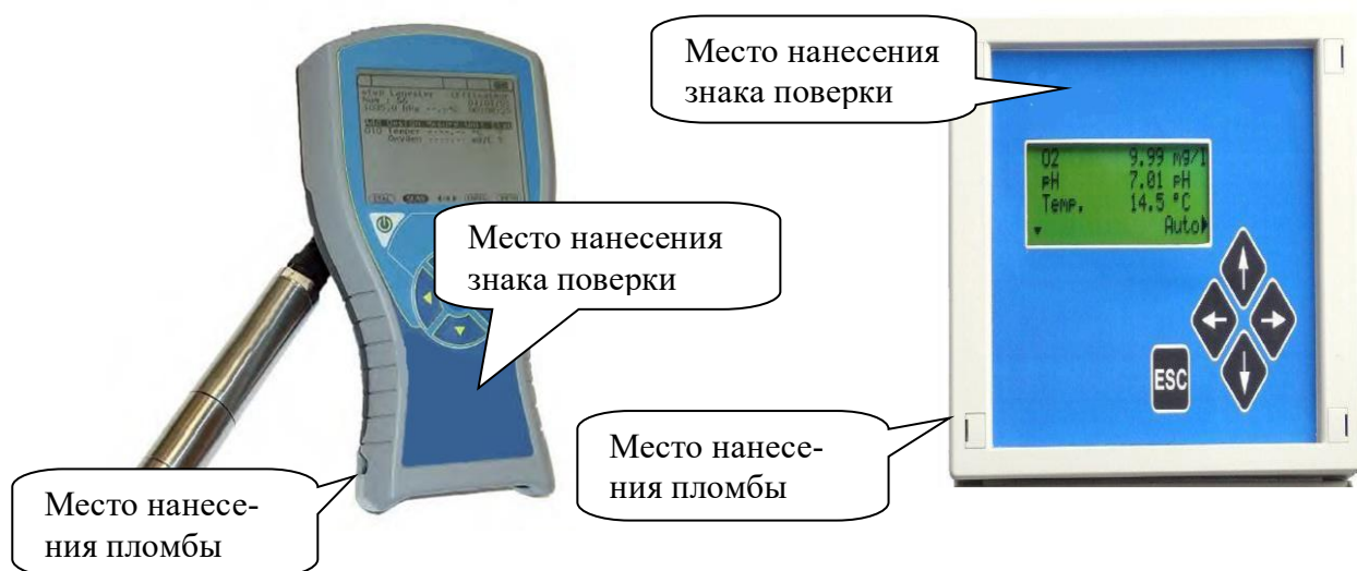
Рисунок 4 – Схема пломбировки от несанкционированного доступа, обозначение места нанесения знака поверки анализатора Аква МП-800.010
