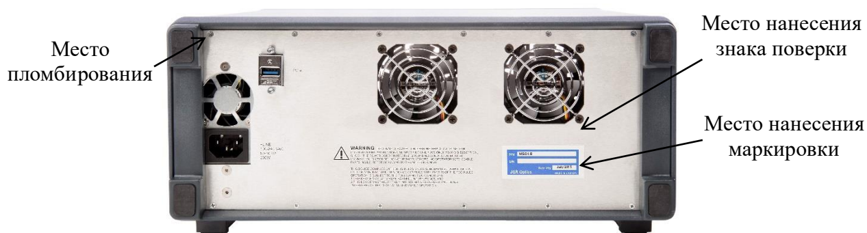
Рисунок 2 – Схема пломбировки от несанкционированного доступа, обозначение места нанесения знака поверки и маркировки
