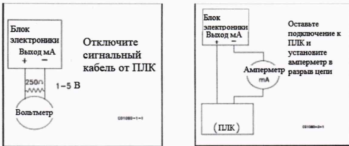
Рисунок 6 – Способы подключения мультиметра в измерительную цепь
