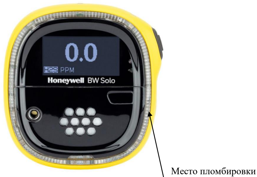
Рисунок 1 – Общий вид газоанализаторов исполнений BW Solo Standart и BW Solo Wireless с сенсорами 1-й серии (1S) и схема пломбировки от несанкционированного доступа
