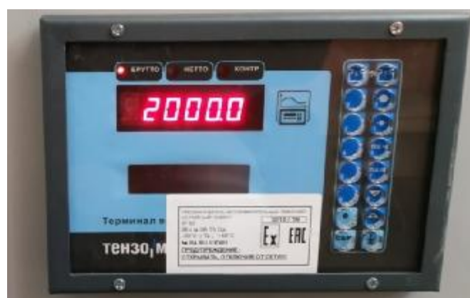
Рисунок 6 – Внешний вид преобразователя весоизмерительного ТВ
