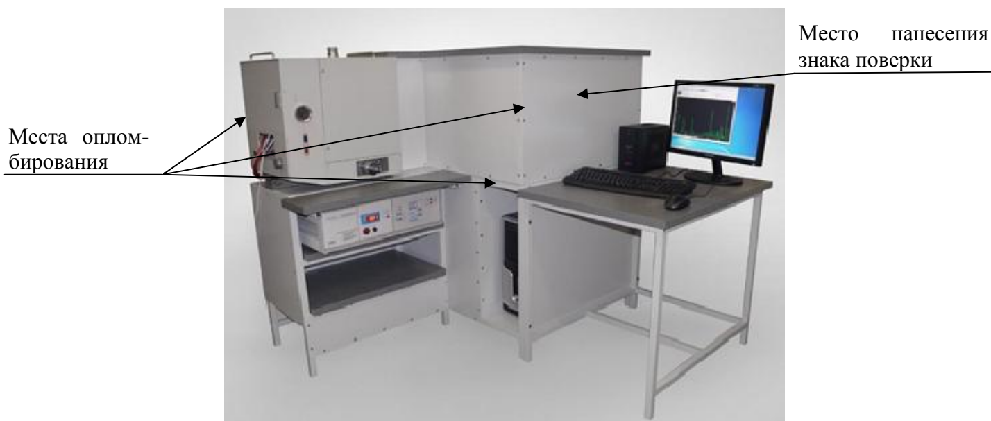
Рисунок 1 – Общий вид спектрометров эмиссионных «СПАС-01»
