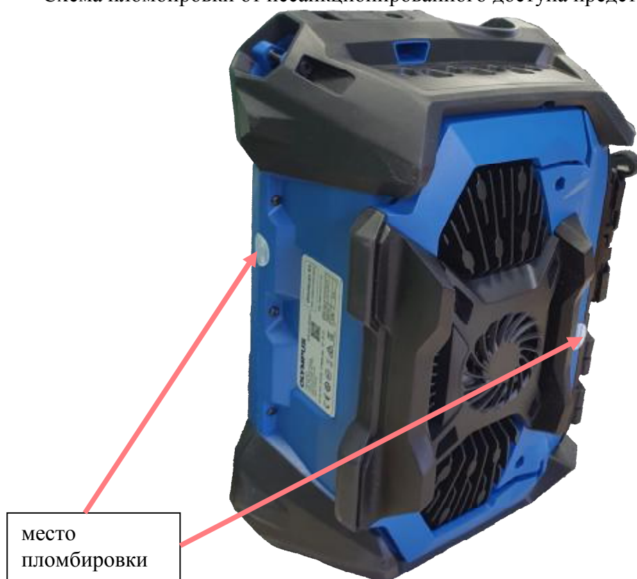
Рисунок 3 – Схема пломбировки от несанкционированного доступа
