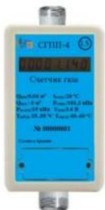
Рисунок 1 – Общий вид счетчиков газа бытовых переменного перепада давления с электронной коррекцией по температуре и давлению и функцией передачи данных и дистанционного отключения подачи газа «СГПП-4»
