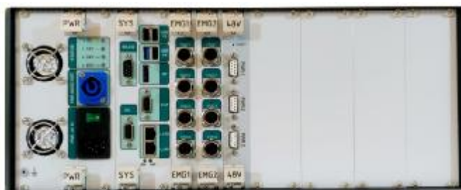
Рисунок 7 – Задняя панель контроллера TMSC
