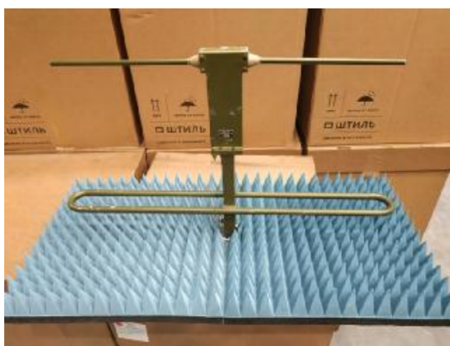
Рисунок 2 – Общий вид антенны-зонда диапазона частот (1,15-0,2) ГГц
