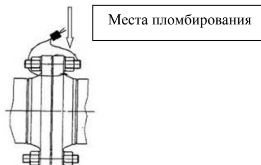
Рисунок 3 – Схема пломбировки от несанкционированного доступа, обозначение места нанесения знаков поверки на фланцевые соединения средств измерений массового и объемного расхода жидкости, массы и объема жидкости в потоке, входящих в состав установки
