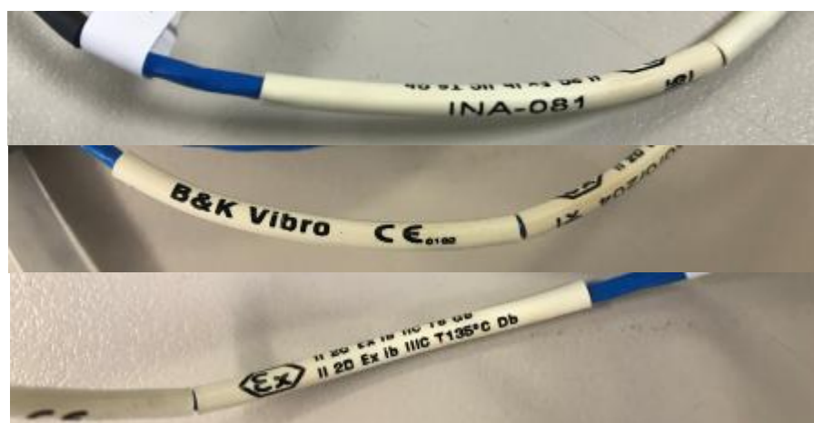
Рисунок 3 – Пример маркировки преобразователей вихрековых серии INA
