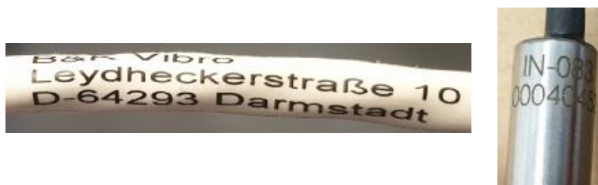
Рисунок 2 – Пример маркировки преобразователей вихрековых серии IN
