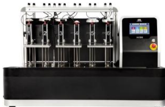
Рисунок 2 – Внешний вид системы для термомеханических испытаний HV6M
