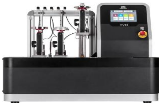
Рисунок 1 – Внешний вид системы для термомеханических испытаний HV3S
