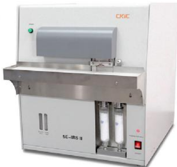
Рисунок 2 – Общий вид анализатора серы инфракрасного 5E-IRS, модификация 5E-IRSII
