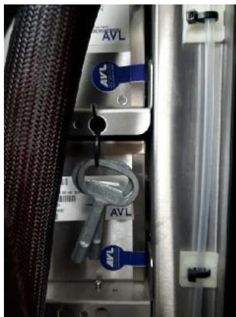
Рисунок 2 – Схема пломбирования корпуса газоанализаторов
