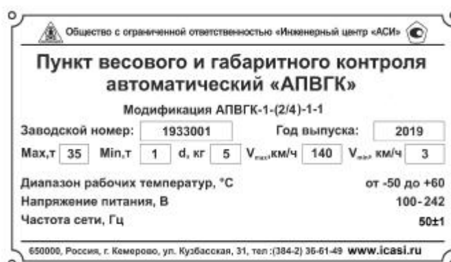
Рисунок 2 – Маркировочная табличка АПВГК
