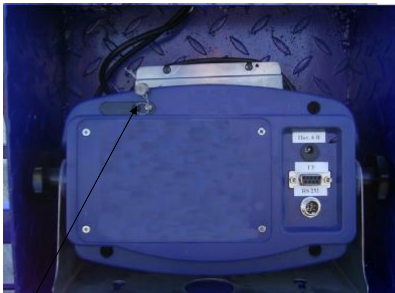
Место пломбирования и нанесения знака поверки (винт доступа к кнопке входа в режим калибровки)
