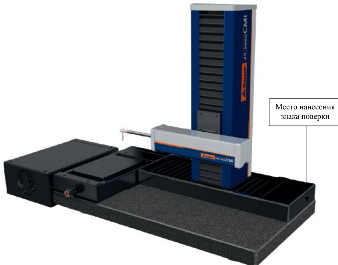
Рисунок 1 – Общий вид приборов для измерений параметров контура поверхности Garant CM1
