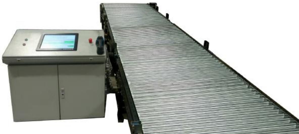
Рисунок 1 — Общий вид средства измерений (пример исполнения с размещением электронных устройств, устройств питания и коммутации в пульте управления)
