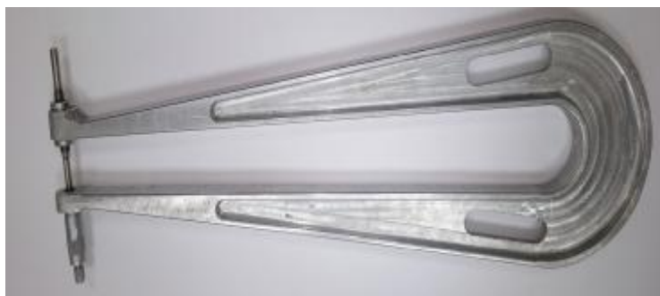
Рисунок 1 – Общий вид скоб микрометрических специальных модификации 934.8124-0013
