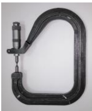
Рисунок 2 - Общий вид скобы микрометрической специальной модификации 934.8124-0015
