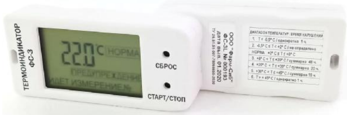
Рисунок 1 – Общий вид термоиндикаторов
