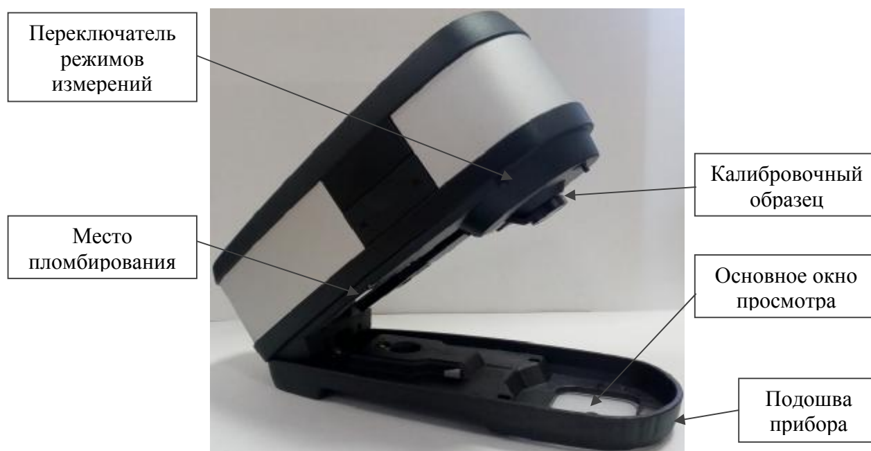
Рисунок 2 - Общий вид денситометров со схемой пломбировки от несанкционированного доступа
