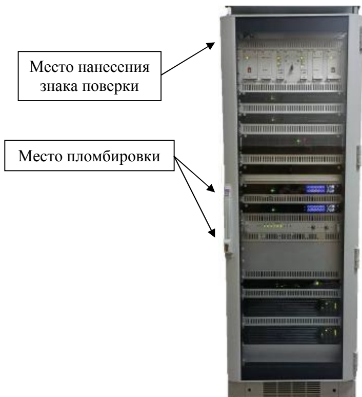
Рисунок 2 – Схема пломбировки от несанкционированного доступа, обозначение места нанесения знака поверки
