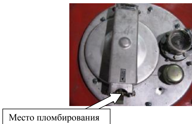
Рисунок 4 – Запорный механизм крышки заливной горловины ПЦ и ППЦ
