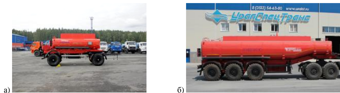
Рисунок 3 – Общий вид а) ПЦ с вариантами исполнения от одной до десяти секций, б) ППЦ с вариантами исполнения от одной до десяти секций
