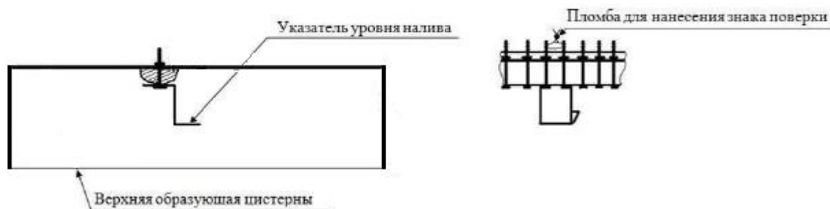
Рисунок 6 – Схема пломбировки от несанкционированного изменения положения указателя уровня налива, обозначение места нанесения знака поверки
