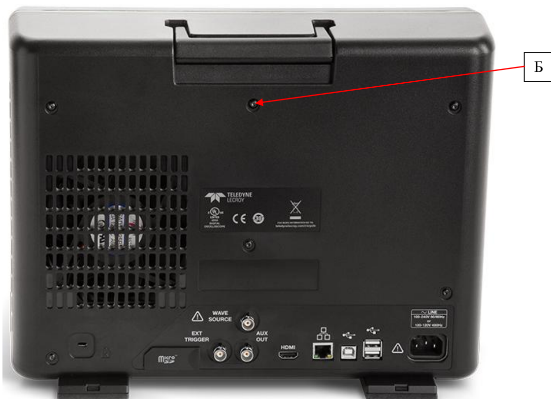
Рисунок 2 – Схема пломбировки от несанкционированного доступа (Б)
