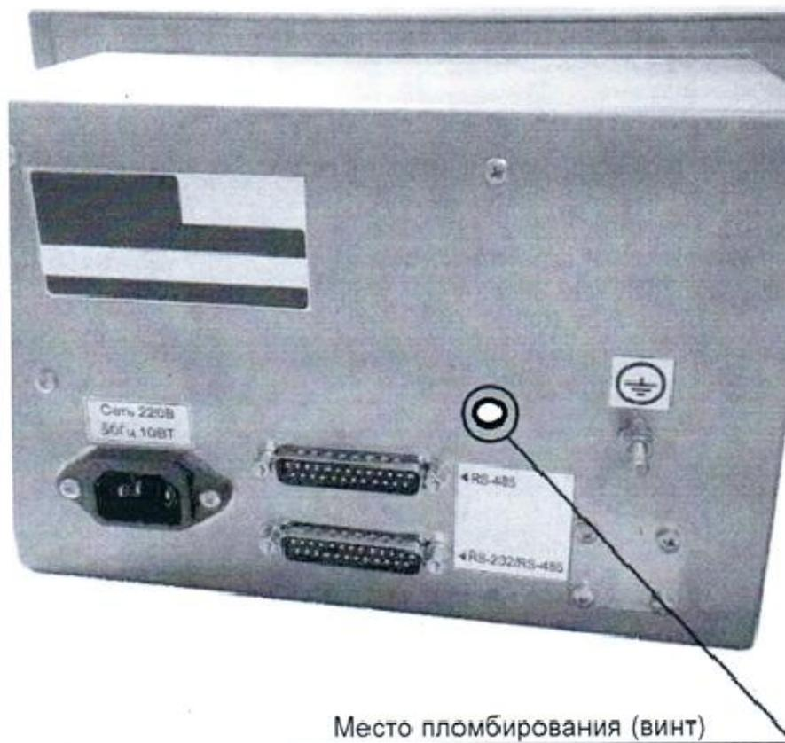
Рисунок 6 – Схема пломбировки индикатора ТЦ017
