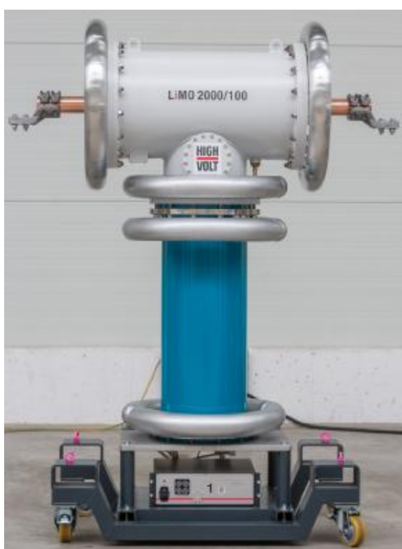
Блок датчиков тока и напряжения LiMO модификаций LiMOS 2000/100 и LiMOS 4000/100
