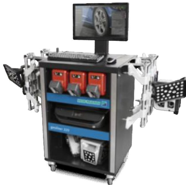
Рисунок 4 – Общий вид устройств для измерений углов установки колес автомобилей торговой марки HOFMANN модели GEOLINER 320 KIT
