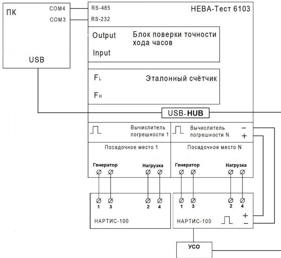
Рисунок А.2 – Схема подключения счётов к метрологической установке
