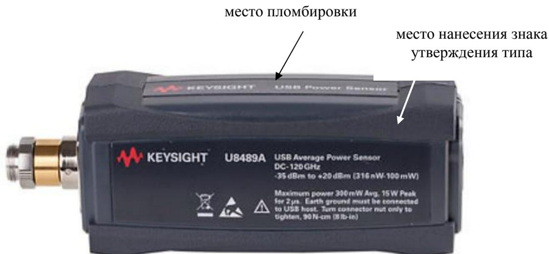
Рисунок 1 – Внешний вид преобразователей измерительных U8481A, U8485A, U8487A, U8488A, U8489A
