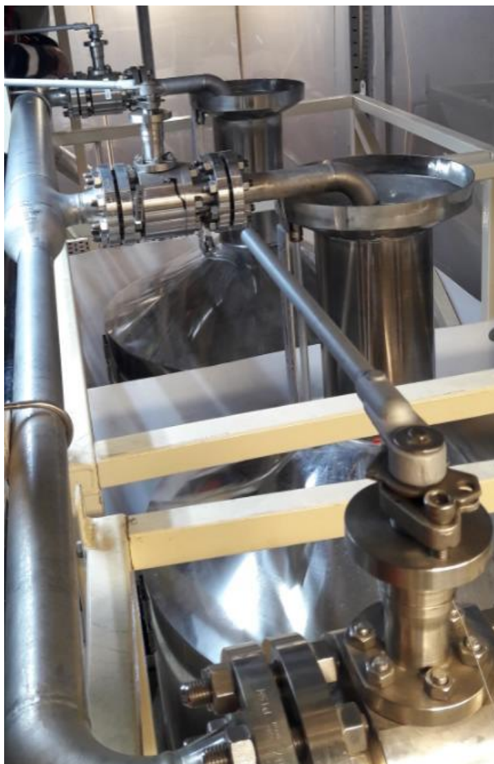
Рисунок 1 - Фотография общего вида установки поверочной на базе мерников
